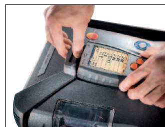
Управляющий модуль просто "защелкивается" в блок анализатора
