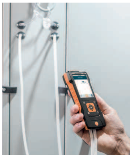
Модель testo 440 dP, включающая сенсор дифференциального давления, позволит вам своевременно принять решение о замене фильтров систем кондиционирования, так, чтобы никакое загрязнение снаружи не попадало в воздух помещения
